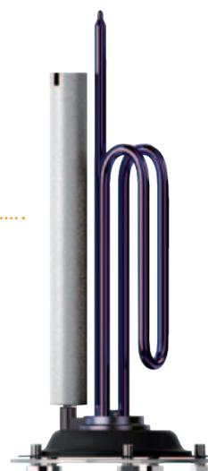
TUTTI GLI SCALDACQUA HANNO IL GRUPPO RISCALDANTE MONTATO SU FLANGIA DI GRANDE DIAMETRO (MM 70) A 5 BULLONI. L'AMPIEZZA DEL FORO E IL PARTICOLARE SISTEMA DI FISSAGGIO FACILITANO LE EVENTUALI OPERAZIONI DI MANUTENZIONE PERIODICA.
